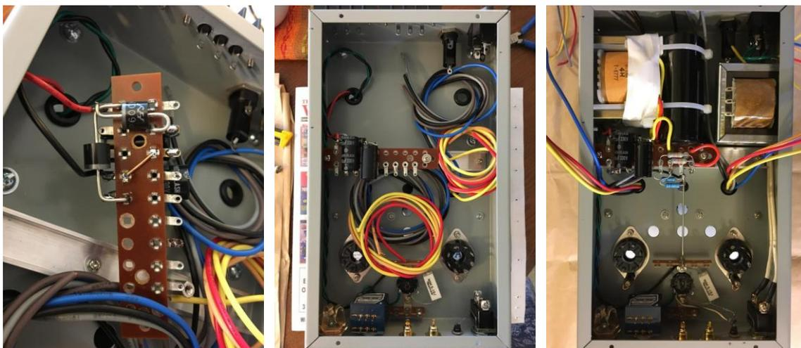
ちょっとややこしいのがヘッドホンジャック(ステレオ)の配線。「情熱の真空管」サイトに親切な配線図があります。とおるさんはもう少し一般的な方法で接続しました(これも末尾に記載)。トランスから出ている3種類(4・8・16Ω)の出力線について、16ΩラインはNFBに用い、4Ωラインはシャシ後面のスピーカ端子に直付け
