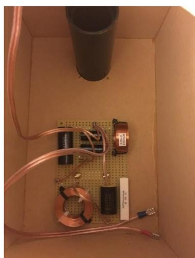
MDF製エンクロージャの接着組立とシンプルな透明ウレタン塗装が終わり、内部にネットワーク回路を組み込んだところ。
