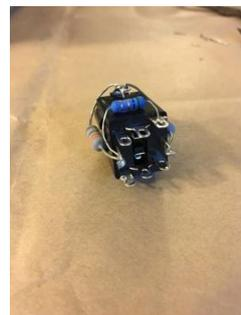
しました。8Ωラインをこのヘッドホンジャックに導き、ヘッドホンプラグが入ると外部スピーカ端子への接続が切れ、代わりに負荷10オームと直列100Ωを介したヘッドホンコイルが並列に接続します。
