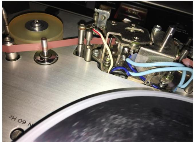
上図左は、ヘッド交換後ヘッドブロックを据え付けた様子。右は、ヘッドブロックを後ろから見た様子。空色のシールドコードの径は3mm強、というところか。硬めのケーブルなので隙間やカバーの内壁に当たって邪魔になる。これを何とか収納して、動作に悪影響しないようにあれこれ工夫しました。
