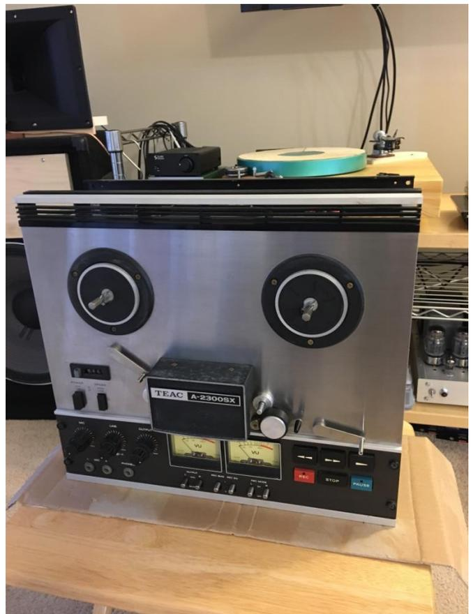
備忘録として： ネット購入後、送付されてきた原器は、木製側板の表面付き板がはがれ、キズ・凹みなど痛みが激しく、ちょうどよい幅の木材を見つけて付け直しました。丈夫なステンレス製パネル面は汚れをふき取りキレイにしました。右下のテープテンションアームは内部でマイクロスイッチと連結しています。テープがリールに巻き取られて曲が完了すると、このテンションアームが解放されて、メカ電源がシャットダウンし、リールモーターとキャプスタンモーターが停止します。このテンションアームのポスト（テープが引っ掛かる棒）が取れてなくなっていたので、有り合わせの部品を付けました。このポストが壊れていたり、側板が傷んでいたり、といういわく付きで、他の展示品よりも安くなっていました。ポチった甲斐があったと自己満足しています。
