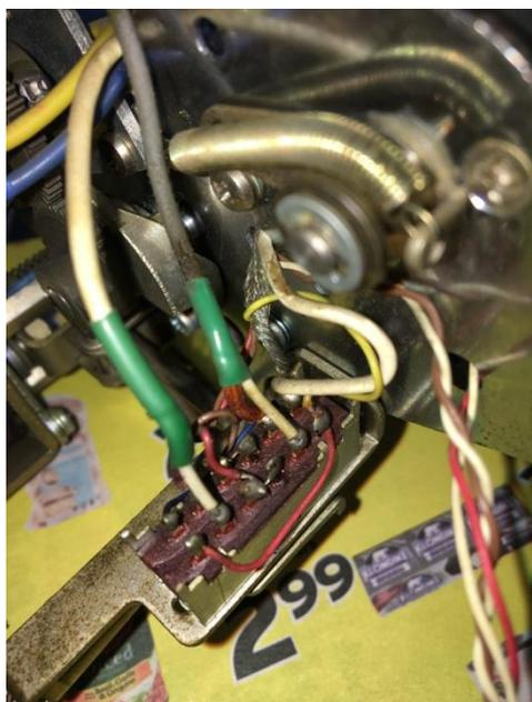
その結果、音の鮮度は上がったような気がしますが、左右のバランスは変わらない。それでは、ということで、再生ヘッドをオーバーホールすることにしました。これまたネットで、同じく AKAI 製の磁気ヘッド単体中古品を見つけ、仕入れた上、ヘッド面 (テープの当たる表面) を平坦に研磨してみました。経時的に磁気テープが当たっている部分で、ヘッド面が削れて段差が手来ています。これを細かなサンドペーパーで平
